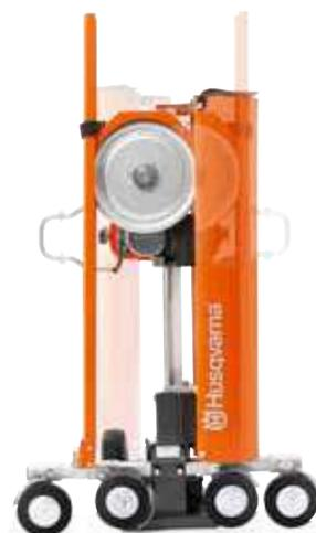
Le modèle CS 10 vous permet de scier à la verticale et à l'horizontale. La tête se monte indifféremment à droite ou à gauche du rail et vous pouvez choisir le sens de marche du câble. Tout ceci vous assure un sciage au câble alliant souplesse et efficacité.
