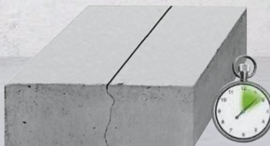
Le système Soff-Cut permet de maîtriser l'apparition de fissures de retrait en découpant le béton à sec à un stade précoce.
