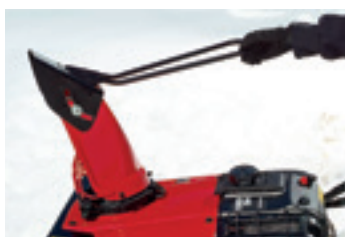
Contrôle manuel de la cheminée sur la HS 750 EMA
