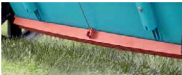
Stop-écoulement pour éviter les fuites de produits grâce aux bandes de fermeture brevetées en pastique souple
